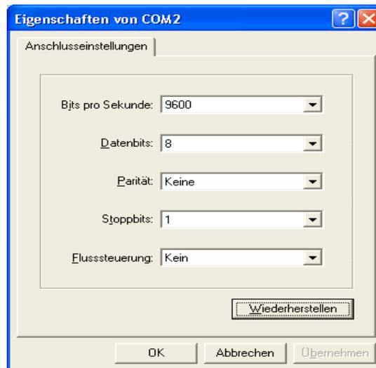
Abbildung 9: Einstellung Kommunikationsparameter serielle Schnittstelle
