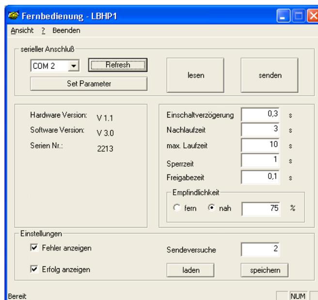
Abbildung 8: Programmfenster Fernbedienung-LBHP1
