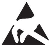
**Vorsicht: Die Baugruppe enthält elektrostatisch empfindliche Bauteile. Der direkte Kontakt mit den Steckverbinderkontakten ist zu vermeiden.**
